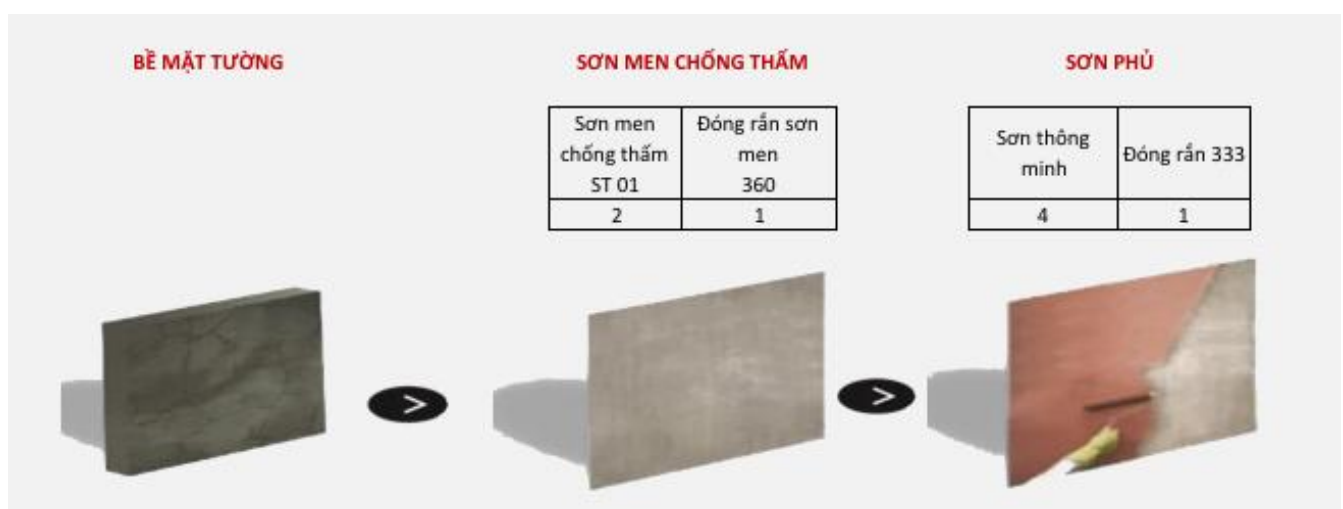
Hình ảnh minh họa cho các bước thi công
