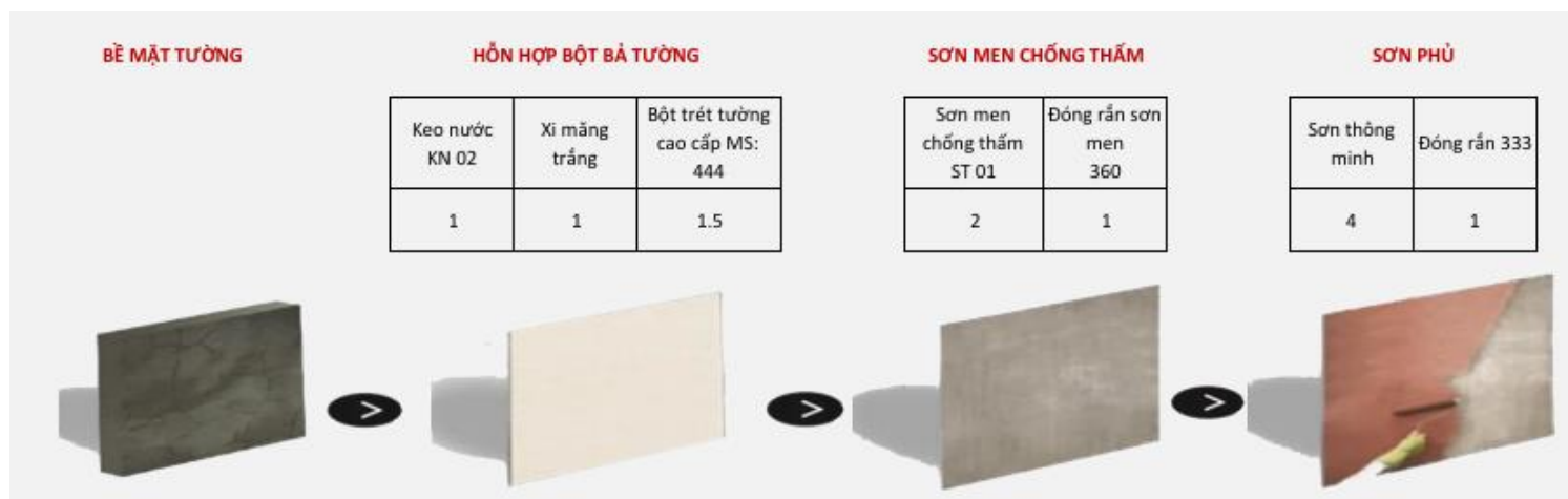
Hình ảnh minh họa cho các bước thi công
