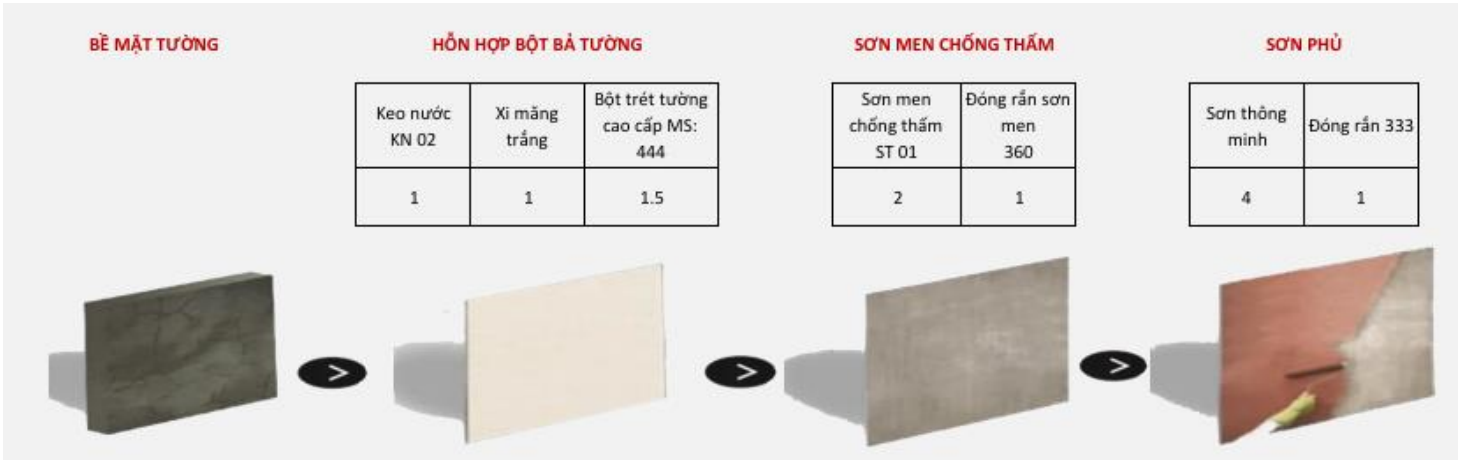
Hình ảnh các bước thi công
